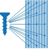
Wenn die Akustikpaneele an der Decke befestigt werden, müssen immer Schrauben verwendet werden.
